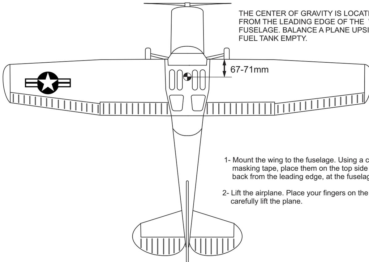
THE CENTER OF GRAVITY IS LOCATED 67 - 71mm BACK FROM THE LEADING EDGE OF THE WING, AT THE FUSELAGE. BALANCE A PLANE UPSIDE DOWN WITH THE FUEL TANK EMPTY.
