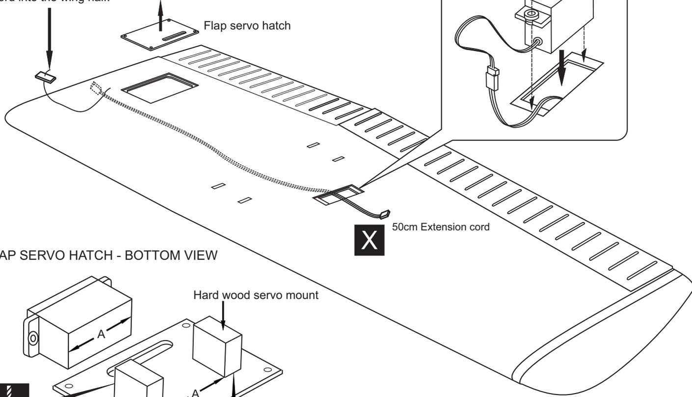
FLAP SERVO HATCH - BOTTOM VIEW
