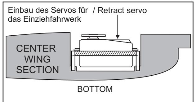
Einbau des Servos für / Retract servo das Einziehfahrwerk
