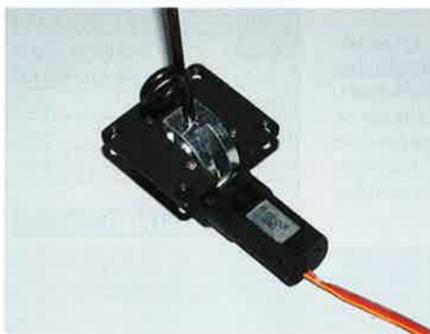
Le mécanisme de train rentrant optionnel est un modèle électrique. Son implantation est particulièrement aisée et bien adaptée au modèle.
