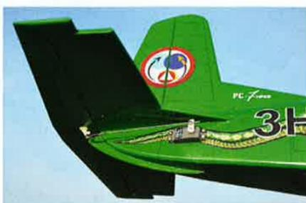
Le servo de profondeur est installé d'origine à l'arrière de la cellule. Ce n'est pas très discret mais ça facilite le centrage car le nez du PC7 est très long.
